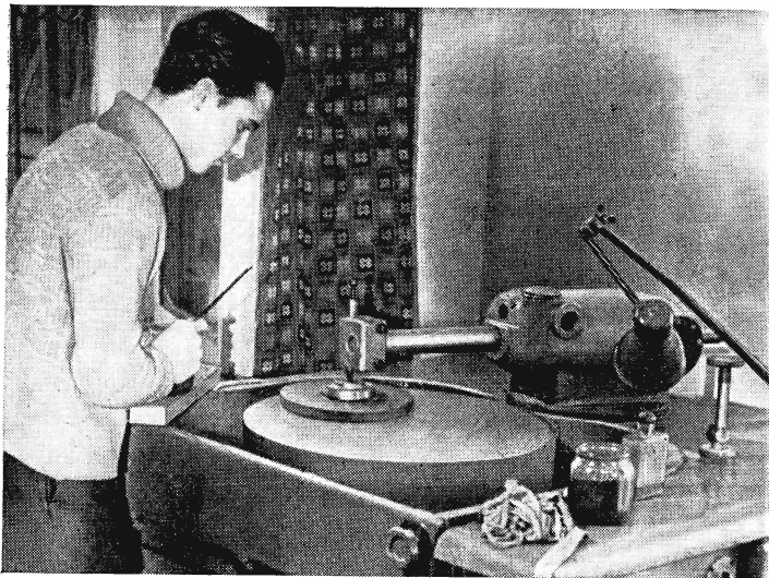
ШЛИФОВКА 520-МИЛЛИМЕТРОВОГО зеркала в Бакинском дворце пионеров и школьников
