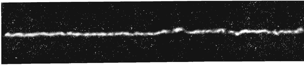
СЛЕД СУТОЧНОГО ДВИЖЕНИЯ ЗВЕЗДЫ (эквивалентное фокусное расстояние 100 м). По амплитуде колебаний следа звезды можно судить о качестве изображения, которое будет получено на большом телескопе
